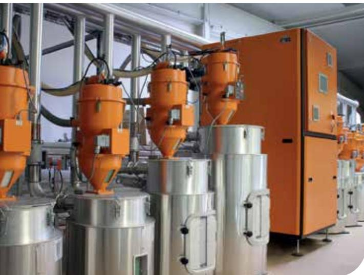
In der Kunststoffverarbeitung spielt die **Granulattrocknung** eine wichtige Rolle. Kunststoff absorbiert Feuchtigkeit aus der Umgebungsluft. Diese kann zu erheblichen Mängeln im Endprodukt führen. Daher ist die **Trocknung von Granulat** ein wichtiger Arbeitsschritt, um die von den Rohstoffherstellern empfohlenen Restfeuchte-Toleranzen unmittelbar vor der Verarbeitung einzuhalten
