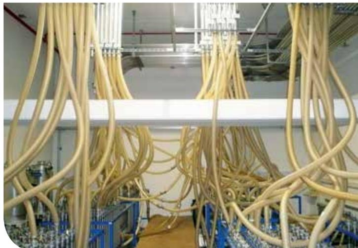
Verteilstation (Schlauchbahnhof), Weiterleitung des Rohstoffes zur Granulattrocknung
