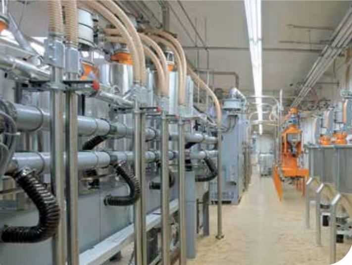
Absaug- und Förderschläuche zum Befüllen der Granulattrockner sowie temperaturbeständige Schläuche zum Fördern der Trocknungsluft
